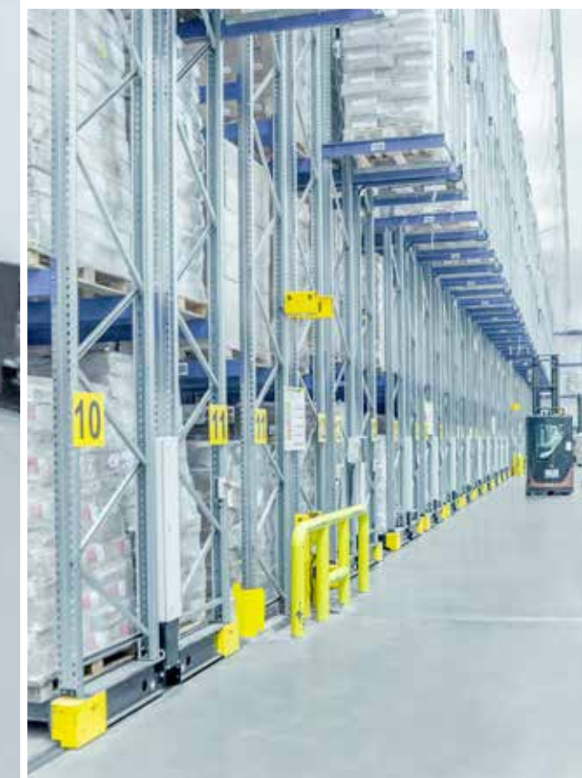
Het vrieshuis heeft twee zones met verrijdbare stellingen van dertien meter hoog.
