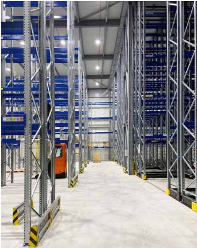
De verrijdbare palletstellingen, opgedeeld in twee zones, bieden plaats aan ruim 6.500 pallets.
